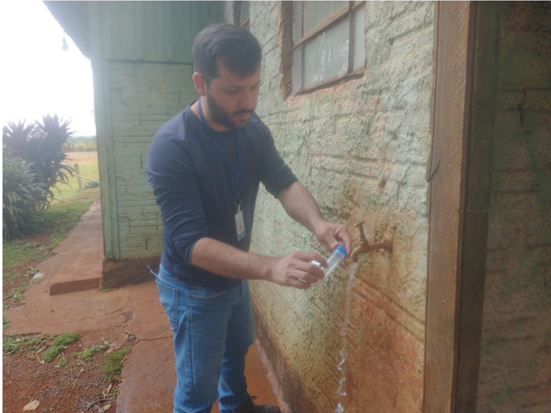
Coleta mensal de amostras de água tratada no POVOADO DA LORENA para análises microbiológicas e físico-químicas realizada pela empresa LLS SERVIÇOS DE SANEAMENTO LTDA.
